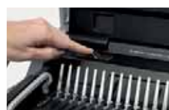
Le guide ajustable améliore la précision de perforation quel que soit le format du document
